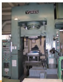
油压冲压机 Hydraulic press machine
