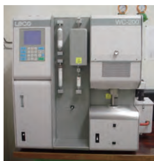
炭素分析装置 Carbon analyzer
