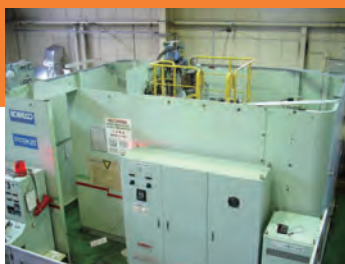
HIP处理装置 Hot Isostatic Pressing (HIP) device
