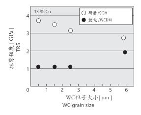
此图表代表放电加工与超硬合金 WC 粒子大小的相关性。WC 粒子越小,放电加工后的抗弯强度就会呈現降低的趋势。
