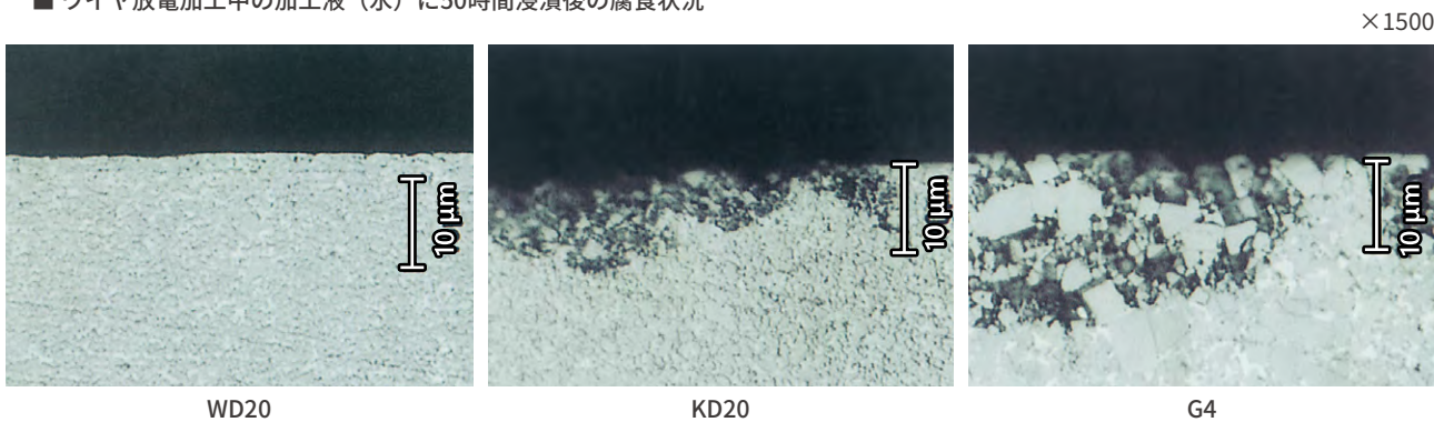
■ ワイヤ放電加工中の加工液 (水) に50時間浸漬後の腐食状況
