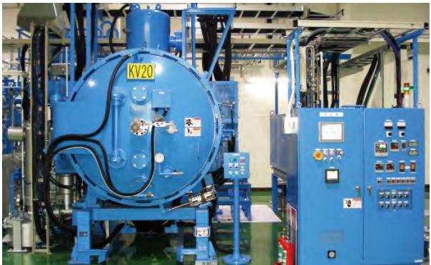
真空・加圧脱脂焼結炉
